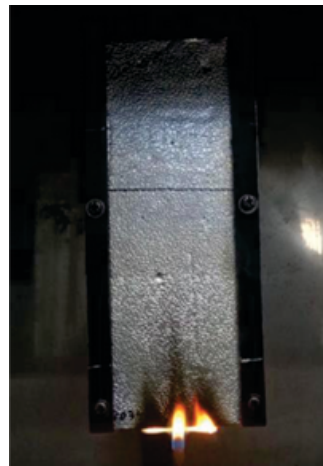
Fotografia 9 – A Chama não atinge a marca de 150 mm.
