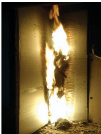
Fotografia 13 – Realização do ensaio pelo método SBI.
